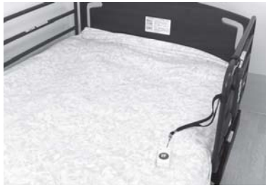
▲ベッドサイドに設置した緊急呼出ボタン。センサー類の移設・増設が簡単
